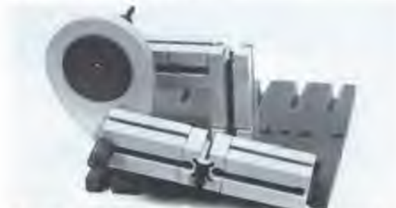
Abb. 13: Anstelle eines Kurbelarmes wird hier eine Kurvenscheibe verwendet. Die Achse für das Gelenk ist in der Kurvenscheibe befestigt.
