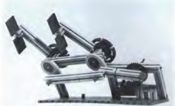
Abb. 25: „Echtes“ Modell eines zweiarmigen Scheibenwischers mit Motorantrieb und Parallelkurbelgetriebe.
