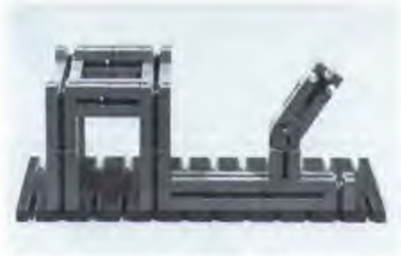
Abb. 19: Auf die Grundplatte ist ein stabiles Gestell montiert. Die Stabilität wird durch die Querverbindung erhöht. Für die Antriebswelle um die Gelenkachse ist jeweils doppelte Stützung möglich. Der Gelenkstein des Wischerarmes kann auf den Bausteinen stufenlos verschoben werden.
