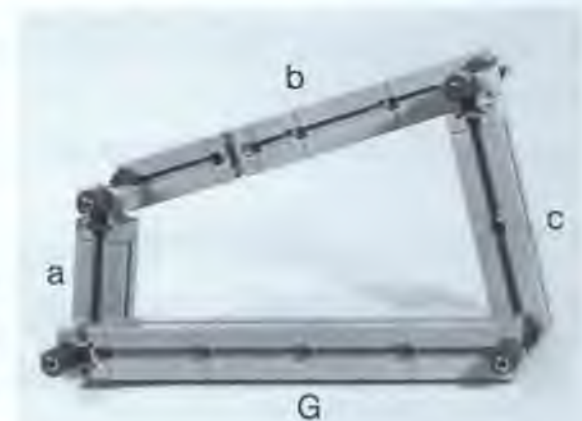
Abb. 2: Modell einer Viergelenkkette aus Bauteilen des u-t 1. Wird G festgehalten, kann nur Glied a eine volle Kreisbewegung durchführen, c nur eine Schwingbewegung. b verkoppelt die beiden Bewegungsabläufe.
