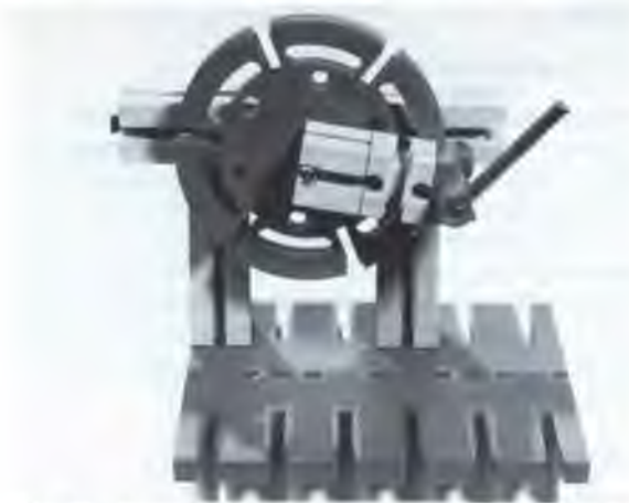
Abb. 12: Der Kurbelarm wurde auf die Drehscheibe montiert. Die Radnabe in der Mitte ist auf der Welle festgedreht. Dadurch ist eine gute Kraftübertragung vom Antrieb auf die Kurbel möglich.
