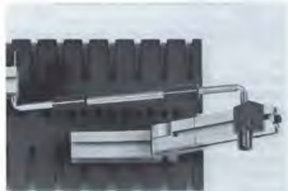
Abb. 14: Die Koppel aus Bausteinen ist zwar stabil, sie wirkt aber schwer.
