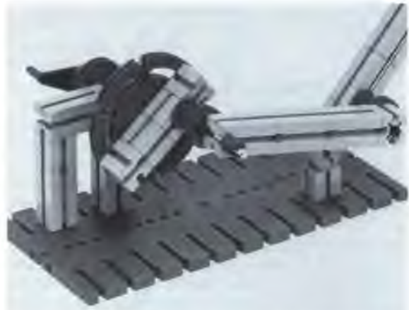
Abb. 14: Die Koppel aus Bausteinen ist zwar stabil, sie wirkt aber schwer.
