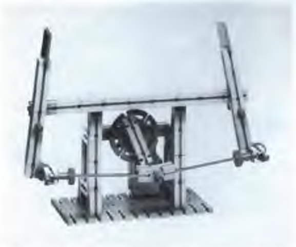
Abb. 26: Funktionsmodell eines zweiarmigen Scheibenwischers mit 2 wirksamen Kurbelschwingen.
