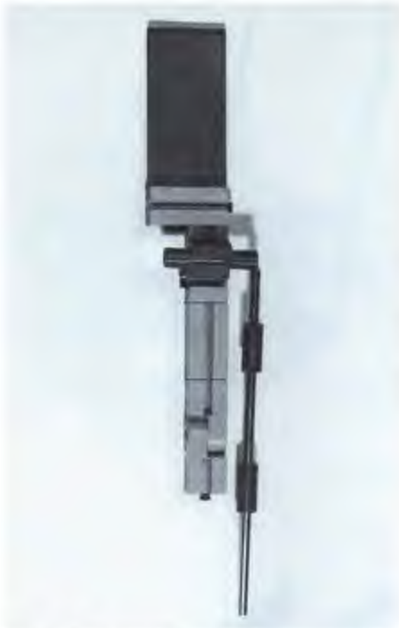
Abb. 17: Der Winkelstein am Wischerarm ermöglicht stufenloses Verschieben des Gelenkes. Das Wischerblatt ist durch eine Bauplatte angedeutet.
