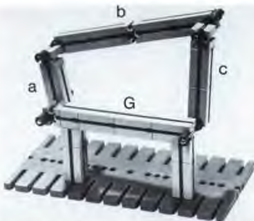
Abb. 4: Kurbelschwinge – das zweitgrößte Glied ist Gestell.
