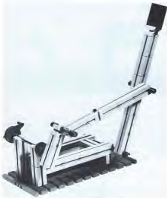
Abb. 22: Funktionsmodell eines einarmigen Scheibenwischers (Viergelenkkette nicht stufenlos verstellbar).
