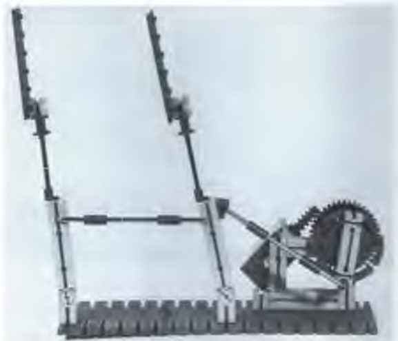
Abb. 24: Funktionsmodell eines motorbetriebenen Scheibenwischers mit zwei Wischerarmen und Parallelkurbelgetriebe.
