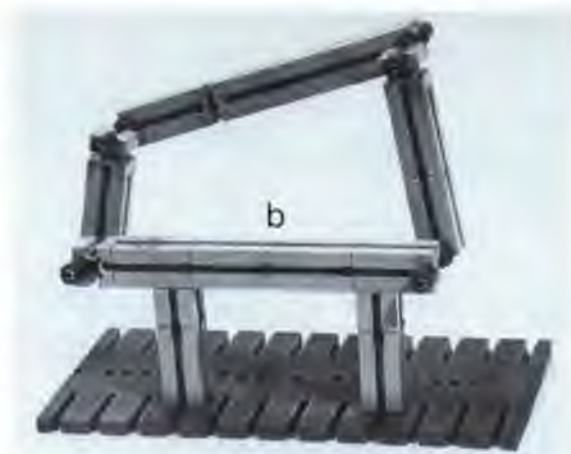
Abb. 5: Kurbelschwinge – das größte Glied ist Gestell.
