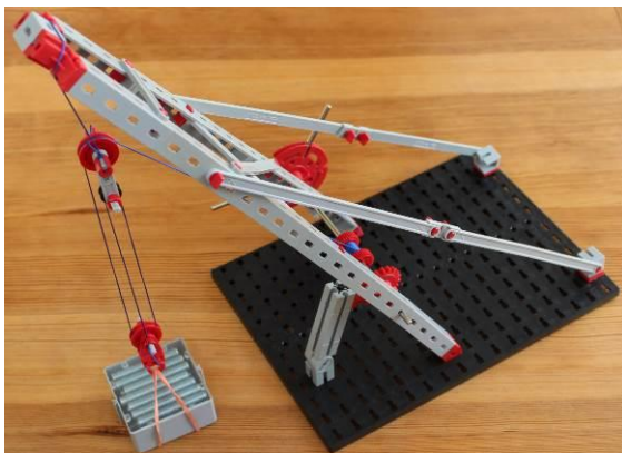
Abb. 3: fischertechnik-Modell eines Trispastos
