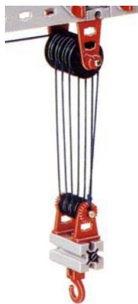
Abb. 9: 7-facher Flaschenzug (aus: Abenteuer-Bau-Buch [4])
