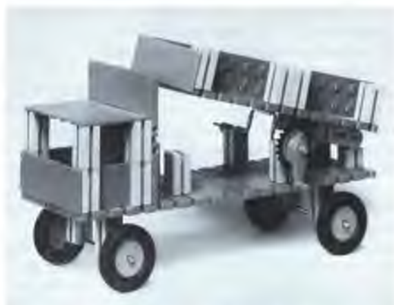
Abb. 41: Kipplaster, Schüler, 4. Schuljahr Eine im Funktionsteil sehr klare und überlegte Konstruktion: Hebemechanismus mit gekröpfter Welle, Sperre (Baustein am Kastenboden) gegen das Durchdrehen der Welle und damit Zurückfallen des Ladekastens. (Zahnrad am Dreher ohne Funktion.) Der gekröpften Welle in der Höhe zugeordnete Drehgelenke und Auflager für den Kasten.
