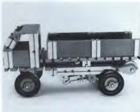
Abb.16 und 17: Kipplaster mit Frontlenkerkabine und großem Kasten. Das Kippen erfolgt mit Hilfe einer Schere, die durch Seilzug geöffnet und geschlossen wird.
