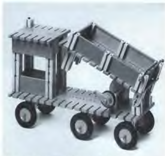
Abb. 42: Kipplaster, 2 Schüler, 3. Schuljahr Etwa dasselbe Konstruktionsniveau wie Abb. 41. Die Exzentrerscheibe schreibt wie die gekröpfte Welle eine hohe Lagerung des Kastens vor, die nicht zweckmäßig ist. Aber dieses Zugeständnis ist unvermeidlich, wenn für den Hebemechanismus die technisch elegantesten Konstruktionen (Welle, Exzenter) angewendet werden sollen. Das Modell wurde in einer Zweiergruppe gebaut. Auch an diesem Modell besticht die schnörkellose Sachlichkeit.
