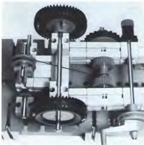
Abb. 20: Ähnliche Konstruktion wie bei Abb. 11, hier wird jedoch die Seiltrommel mit einer Übersetzung ins Langsame (2:1) angetrieben.
