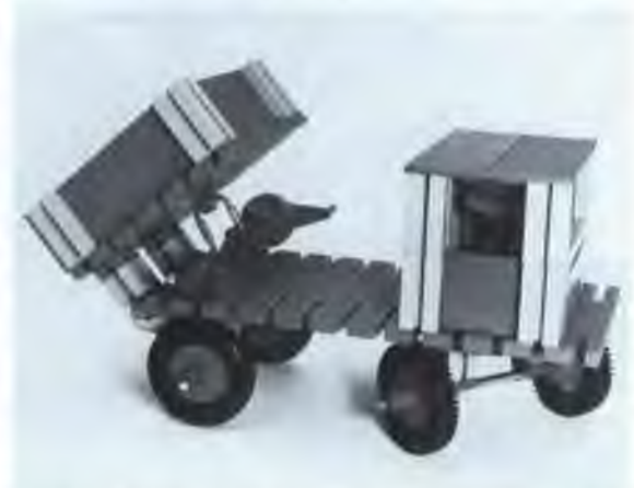
Abb. 13: Kipper mit Drehschemellenkung, die durch eine Lenkstange betätigt wird. Heben und Senken des Kastens erfolgt mit Hilfe einer Kurbelwelle.
