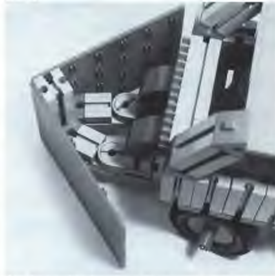
Abb. 28 und 29: Lenkbarer Lastwagen mit Keilschneepflug. Aus Abb. 29 ist die Befestigung des Pflugs ersichtlich.
