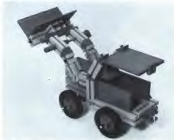
Abb. 32 und 33: Traktor mit Ladeschaufel. Die Schaufel muß durch Hochführen des Auslegers angehoben werden; die Stellung der Schaufel selbst kann durch einen Seilzug verändert werden.
