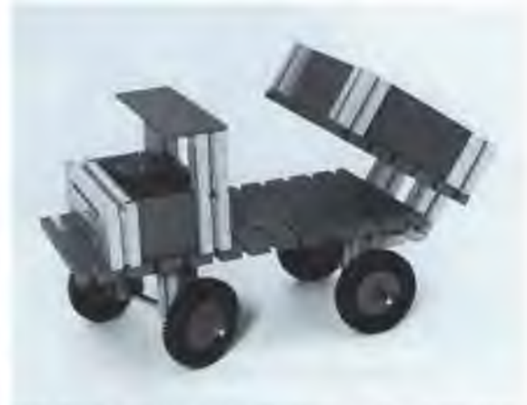
Abb. 11: Kipplaster mit Drehschemellenkung; der Drehschemel besteht aus Drehscheibe und zwei Bausteinen 30. Die Lenkung kann durch ein Lenkrad betätigt werden. Der Kippkasten muß unmittelbar mit der Hand angehoben werden.
