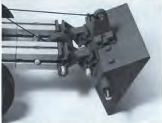
Abb. 38 und 39; Radlader aus fischertechnik-Bauelementen, die als Sonderbauteile erhältlich sind. Die Kabine besteht aus zwei Führerhaus-Seitenteilen und Bauplatten 30x45 mit Zapfen. Die Reifen haben einen Durchmesser von 60 mm. Die Ladeschaufel ist aus zwei Schaufelseitenteilen und drei Zwischenteilen zusammengesetzt. Das Fahrzeug ist mit einer Knicklenkung ausgestattet. Wie bei allen gelenkten Modellen müssen dabei die Räder lose auf die Achsen gesetzt werden; Klemmbuchsen von nur 5 mm Länge verhindern ein seitliches Verschieben der Räder.
