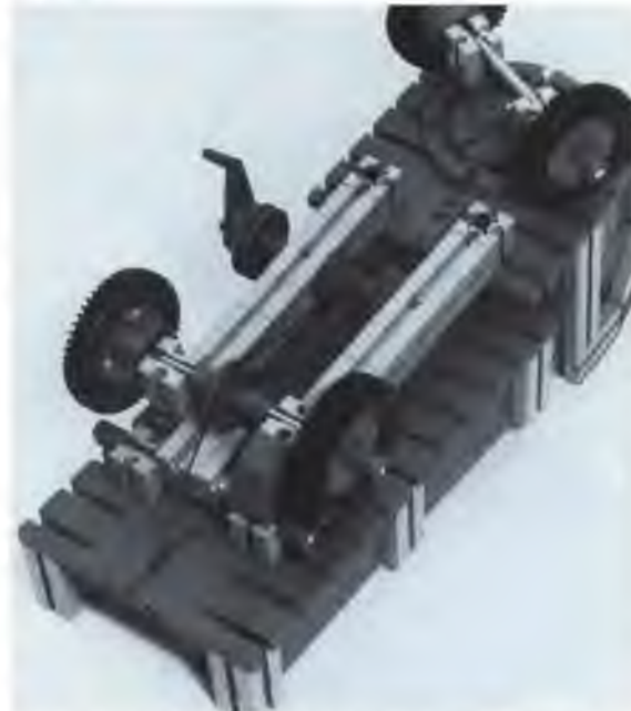
Abb.18 und 19: Lenkbarer Kipplaster mit großem Kasten. Anheben und Senken des Kippkastens erfolgt mit Seilzug. Um einen günstigen Zugwinkel zu erreichen, wird das Seil über eine Umlenkrolle unter der Hinterachse durchgeführt.
