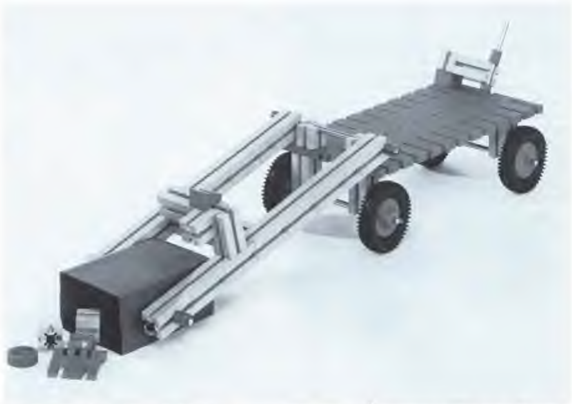
Abb. 48: Schürflader, Schüler, 4. Schuljahr Dieser „overhead“ (= über Kopf) entladende Schürflader ist unter Mithilfe des Lehrers konstruiert worden. Die Entladung über das Fahrzeug hinweg wurde mit Hilfe eines freihängenden Schürfeimers gelöst, der kraft seines Gewichts nach unten hängt, gleichgültig, in welcher Stellung sich die Trägersäule befindet. Die Entladung
