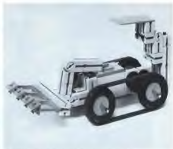
Abb. 46: Schürflader, Schüler, 4. Schuljahr Ein äußerlich lebhaftes und formschönes Modell von jedoch im Gegensatz dazu niedrigem technischen Niveau. Reiche Ausrüstung: Raupenbänder, zähnebewehrter Schild, Schutzdach. Der Räumschild ist bei nur geringem Spiel durch Zug und Druck an einem kurzen Hebel zu heben und zu senken. Keine Ladungsbewegung, kein Fassungsvermögen des Schilds bzw. Kübels.
