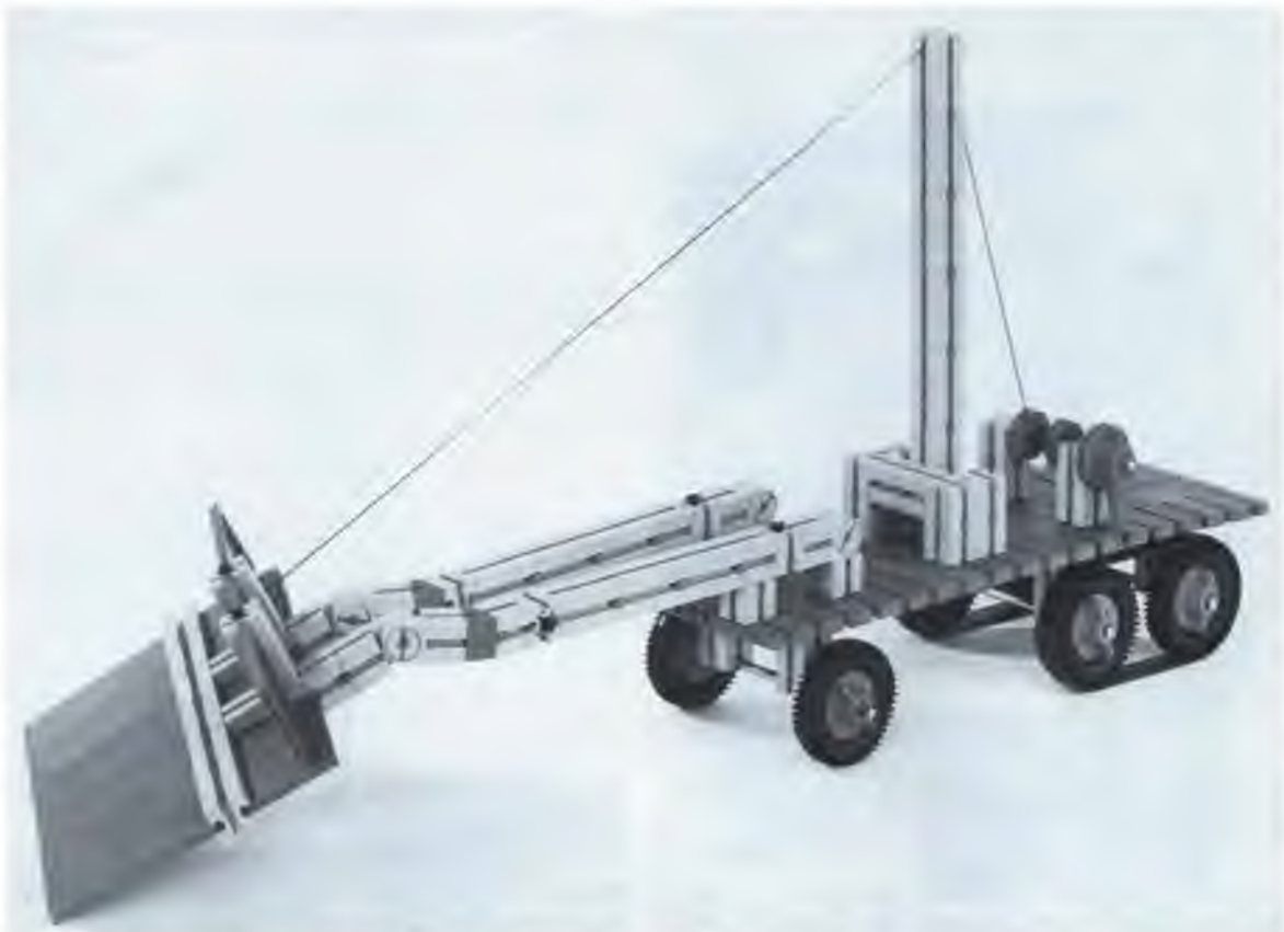
Abb. 45: Schneepflug, Schüler, 3. Schuljahr Voller technischer Phantasie. Der (in Abwehrhaltung?) weit vorgeschobene Schild wird durch zwei Träger stabilisiert. Durch Vertauschen zweier Steine ist er umlenkbar! Der Schild durch Größe und Konstruktionsaufwand als der Hauptteil des Modells betont. Das wichtigste Interesse des Schülers war es aber wahrscheinlich, den Räumschild kippbar zu machen. Obwohl vom
