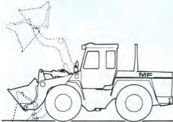
Abb. 9: Schürflader, schematisch, 4 Arbeitsstellungen.
