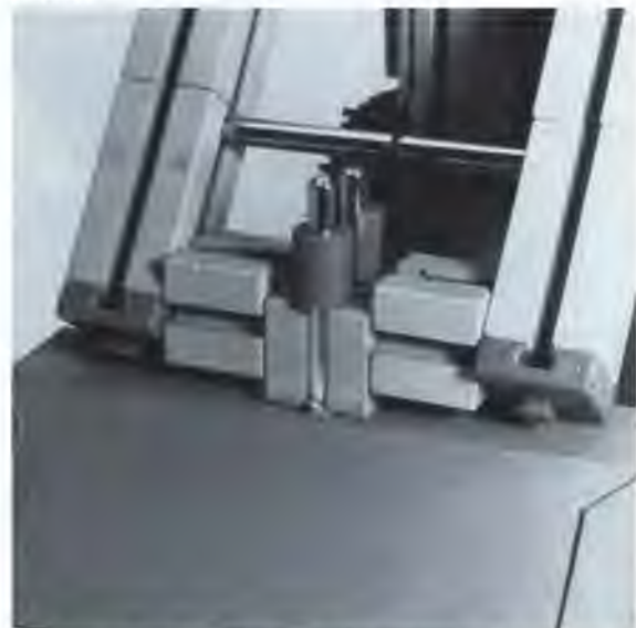
Abb. 34 und 35: Frontlader mit Ladeschaufel aus Pappe. Die Schaufel kann mit Hilfe eines Seilzugs angehoben werden. Ihre Stellung wird durch Verdrehen der Schaufel selbst verändert. Wie dies erreicht wird, ist aus Abb. 35 zu ersehen; am mittleren Baustein 15, der die Schaufel trägt, sind mit Hilfe von Verbindungsstücken 15 links und rechts Bausteine mit rundem Zapfen montiert.
