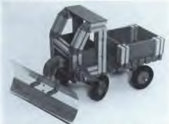
Abb. 27: Lenkbarer Lastwagen mit einseitigem Schneepflug. Der Schild besteht aus Aluminiumblech. Die Befestigung erfolgt in gleicher Weise wie bei Abb. 25. Der Räum schild kann mit einer Handkurbel angehoben werden; hierzu wurde die Kurbelachse durch einen Baustein 30 mit Bohrung geführt, auf welchen an beiden Seiten Seiltrommeln aufgesetzt wurden. Die Lagerreibung ist so groß, daß der angehobene Schild in jeder beliebigen Stellung stehen bleibt. Ein seitliches Schwenken des Räum schilds erfolgt durch Verdrehen des Pflugträgers.
