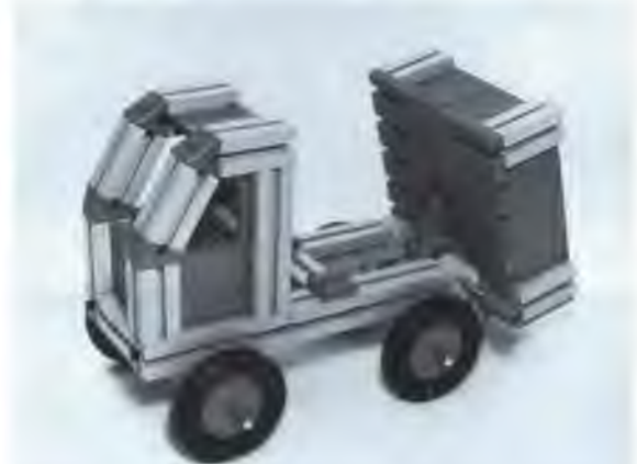
Abb. 12: Kipplasterwagen mit Frontlenkerkabine. Der Kasten wird durch Drehen an der seitlich etwas herausstehenden Achskupplung angehoben und gesenkt. Als Mitnehmer dient der Kurbelarm der eingebauten Handkurbel, deren Griff am Kastenboden festgebunden ist. Das Modell hat keine Lenkung.
