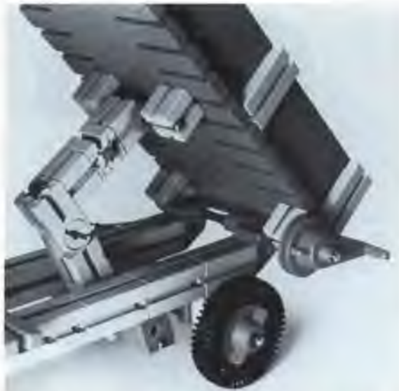
Abb.17: Die Achse des Kippgelenks dient gleichzeitig als Antriebsachse für den Seilzug. Das Seil ist mit einer Klemmbuchse auf der Achse befestigt.
