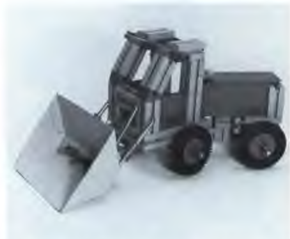
Abb. 36 und 37: Radlader mit Ladeschaufel aus Pappe. Das Fahrzeug ist mit einer Knicklenkung ausgestattet. Die Schaufel kann mit Hilfe eines Seilzugs angehoben und durch einen Handhebel (Abb. 37) gekippt werden. Das Zugseil ist mit Klemmbuchsen auf der Achse befestigt.
